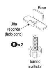
B) Coloca la base de manera inclinada apoyando la uña redonda (lado corto) a la mampara y empuja, asegúrate que la uña rectangular de la base coincida con la cara de las mamparas que tienen las correderas
