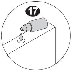
Coloca pegamento (8 gotas por barreno) a todos los barrenos donde vas a insertar **67**
